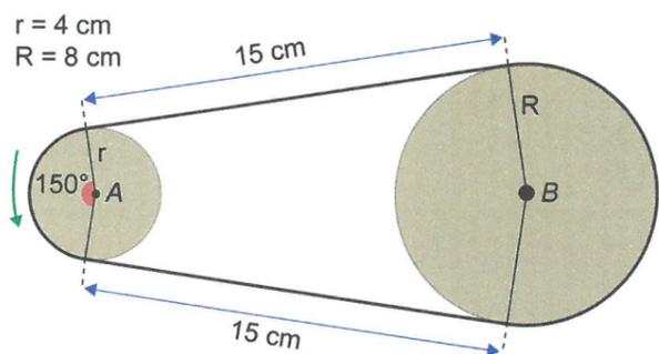
Para substituição dessa correia, é necessária a especificação de seu comprimento.
