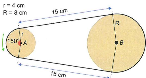
Para substituição dessa correia, é necessária a especificação de seu comprimento.
