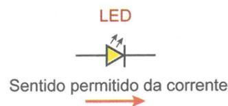
Um estudante de física analisa as propriedades do LED em um circuito simples de corrente contínua. Ele dispõe dos seguintes materiais: uma bateria ideal de 4,5 V; dois LEDs de tensão 3,0 V e  $I_{\text{máx}} = 1,0$  mA cada; e dois resistores de 1,5 k $\Omega$  cada.
