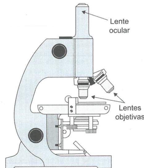
O funcionamento desse microscópio permite o uso da lente ocular sozinha ou a combinação dela com uma de suas lentes objetivas, proporcionando, nesse caso, um aumento de sua capacidade de ampliação final, que é dada pelo produto entre as capacidades de ampliação da ocular e da objetiva.
